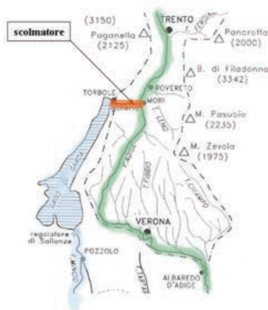
Figura 8. Ingresso e tracciato della galleria Mori-Torbole
