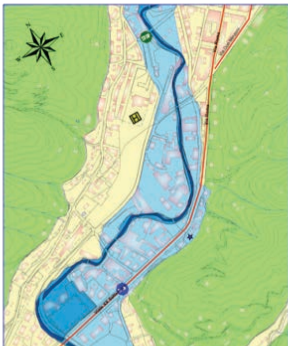
Figura 2. Stralcio di tavola di rischio idrogeologico con le aree a diversa pericolosità
