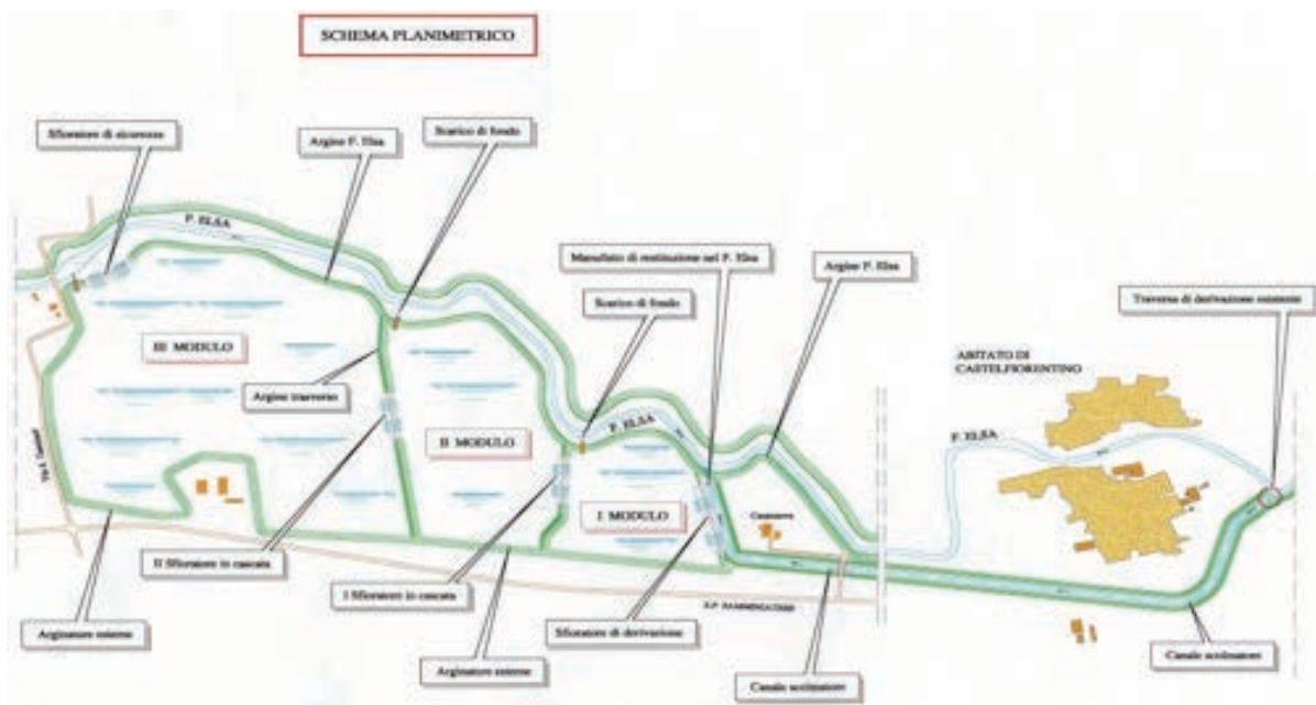
Figura 4. Esempio di cassa di espansione in derivazione articolata in tre moduli e avente un'estensione di 164 ettari; in caso di piena vi defluiscono le acque del fiume Elsa, a salvaguardia del Comune di Castelfiorentino (FI)
