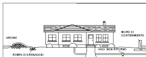
Figura 15. Esempio combinato di sistemi di protezione dal rischio idraulico per edifici ubicati in aree a rischio
