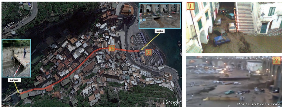
Figura 9. La tombatura del torrente Dragone nel centro abitato di Atrani. La sua inefficacia in occasione dell'evento del 2010 appare evidente (da Bovolín, 2014)
