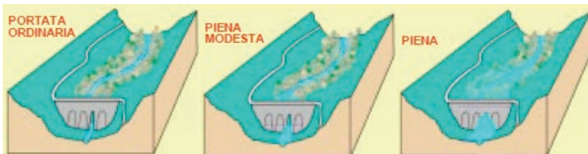
Figura 2. Schema di funzionamento di una cassa d'espansione in linea
